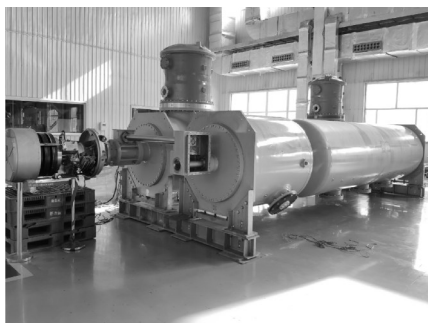
图2 特高压GIS四断口断路器测试样机
